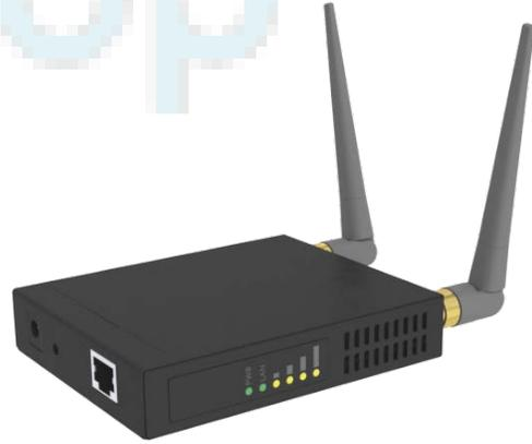
AR1 2Mi 体积小，是一款高性能、高稳定性的 2.4GHz 无线 AP 产品，专为室内应用而设计。产品最大功率可达 30dBm，内部集成具备 MIMO 2x2 技术的先进 802.11n 无线内核，并且向下兼容 802.11b/g 产品，具有可靠、先进、功能丰富的操作系统，可以快速、安全、高效的提供稳定高速的无线网络连接。AR1 2Mi 可工作于接入点、工作站及中继模式，支持桥接和路由，因此可灵活的适应多
