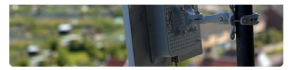
AirFi P5-23 MIMO 是工作在 5G 免许可频段高容量远距离的 MIMO 系列点对点无线网桥产品 °该系列 产品开创性的应用 2×2 MIMO 技术 实现吞吐量高达 180 Mbps~90 Mbps 全双工 ) 并具备强大的 PPS 数 据包处理能力。
